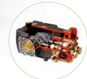
Radiale krukaspomp met messing pompkop, keramische pluniers en RVS kleppen
