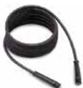
Hogedrukslang 10 m met draaikoppeling. 315 bar, 150°C 3.8007.TBAP25324
